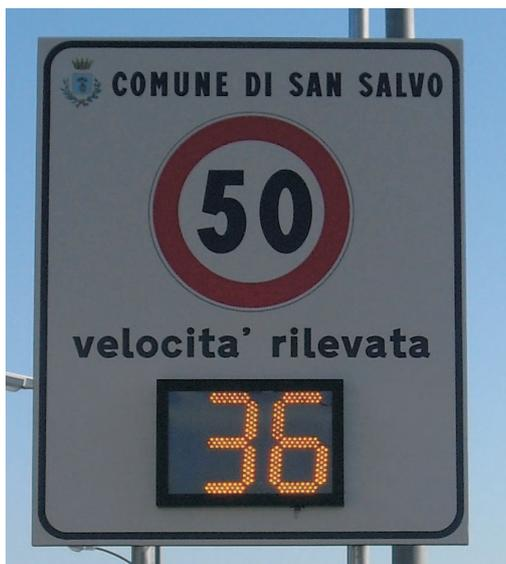
Targa per il rilevamento e segnalazione della velocità.
