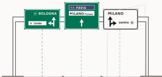
FIGURA 246 SEGNALE DI CORSIA CON FUNZIONE DI PREAVVISO
