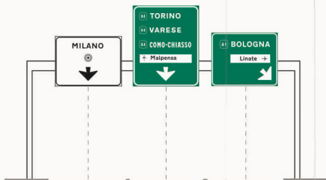
FIGURA 250 SEGNALE DI CORSIA CON FUNZIONE DI DIREZIONE
