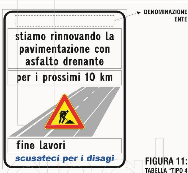
TUTTI I CARTELLI IMPIEGATI NELLE SEGNALETICHE DI CANTIERE DEVONO ESSERE REALIZZATI CON PELLICOLA RIFRANGENTE MICROPRISMATICA AD ALTA VISIBILITÀ "DIAMOND GRADE" (O CON PRESTAZIONI EQUIVALENTI) E MANTENUTI IN CONDIZIONI OTTIMALI DI EFFICIENZA
