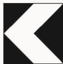
FIGURA II 468 ART. 174 DELINEATORI MODULARI DI CURVA SONO INSTALLATI IN SERIE DI PIÙ ELEMENTI LUNGO IL LATO ESTERNO DI CURVE STRADALI ED AUTOSTRADALI PER MIGLIORARE LA VISIBILITÀ DELL'ANDAMENTO DELLA STRADA A DISTANZA
