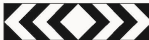
FIGURA II 467 ART. 174 DELINEATORE PER INTERSEZIONE A "T" È INSTALLATO DI FRONTE AL RAMO DELLA INTERSEZIONE CHE NON PROSEGUE ED INDICA LA NECESSITÀ DI SVOLTARE A DESTRA O A SINISTRA
