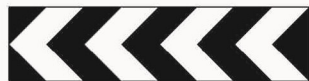
FIGURA II 466 ART. 174 DELINEATORI DI CURVA STRETTA O DI TORNANTE SEGNALA LA PRESENZA DI UNA CURVA STRETTA PERMANENTE, OVVERO DI UN TORNANTE, E INDICA LA DIREZIONE DA SEGUIRE
