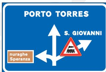
SEGNALE DI PREAVVISO DI INTERSEZIONE EXTRAURBANA CON PASSAGGIO A LIVELLO SU UN RAMO DELL'INTERSEZIONE
