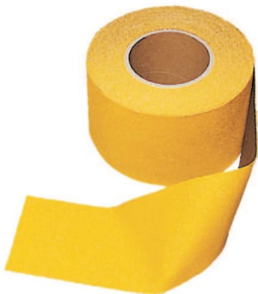
I laminati elastoplastici sono adesivi in resina poliuretana ad alta rifrangenza, antisdrucciolo, contenenti microsfere di vetro; applicabili a mano o a macchina. I laminati elastoplastici sono particolarmente indicati per le applicazioni di segnaletica da cantiere, questi sono facilmente removibili grazie alla rete inserita nella base.
