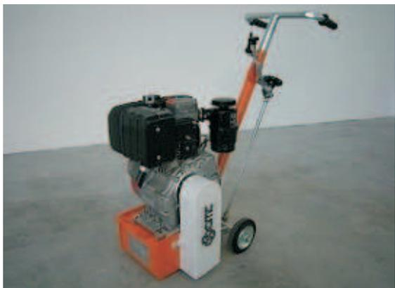
Cancellazione di segnaletica orizzontale mediante macchina fresatrice:
