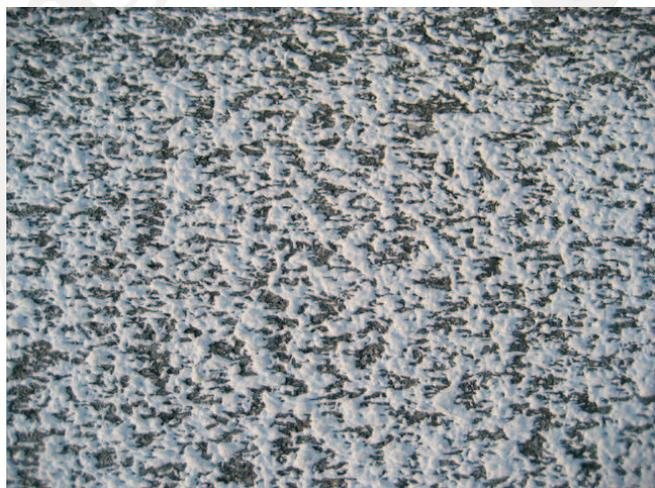
Il “gocciato” offre all'utente il massimo delle caratteristiche prestazionali. Si distingue dalla segnaletica tradizionale per il suo spessore e per la sua superficie irregolare formata appunto da gocce e piccola chiazze di spessore variabile tra i 2 e 5 mm.
