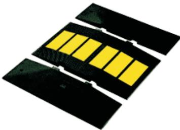
DOSSO ARTIFICIALE H. 5 cm realizzato in gomma vulcanizzata a profilo convesso con superficie antisdrucchiolevole. Sono ricoperti in maniera parziale da laminato elastoplastico rifrangente di colore giallo per migliorare la visibilità - installazione su strade con limite massimo di velocità 40 km /h
