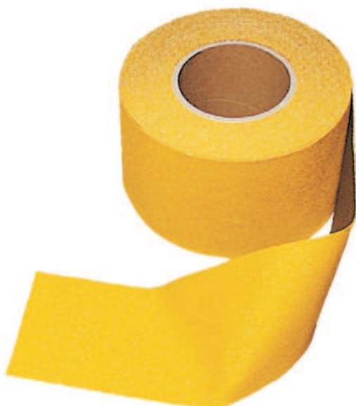
**I laminati elastoplastici sono adesivi in resina poliuretana ad alta rifrangenza, antisdrucchiolo, contenenti microsfere di vetro; applicabili a mano o a macchina. I laminati elastoplastici sono particolarmente indicati per le applicazioni di segnaletica da cantiere, questi sono facilmente removibili grazie alla rete inserita nella base.**
