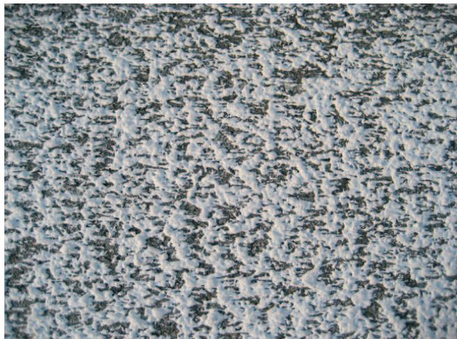
Il “gocciato” offre all’utente il massimo delle caratteristiche prestazionali. Si distingue dalla segnaletica tradizionale per il suo spessore e per la sua superficie irregolare formata appunto da gocce e piccole chiazze di spessore variabile tra i 2 e 5 mm.
