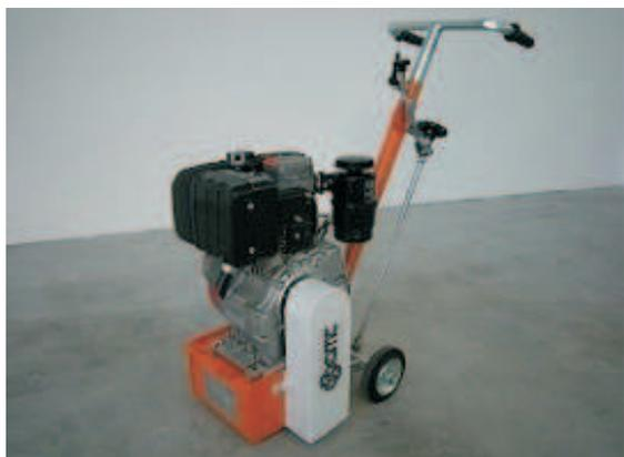
**Cancellazione di segnaletica orizzontale mediante machina fresatrice:**
